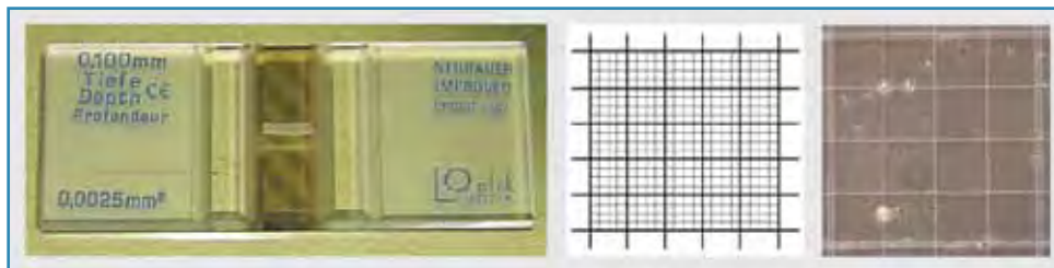
Figura 5. Câmara de Neubauer modificada (à esquerda). No centro, ilustração representando seu retículo central, que contém 25 quadrados subdivididos em 16 quadrados menores. À direita, fotomicrografia mostrando um dos 25 quadrados do retículo central da câmara, delimitado por linhas triplas e contendo 16 quadrados menores, nos quais se observam os espermatozoides.
